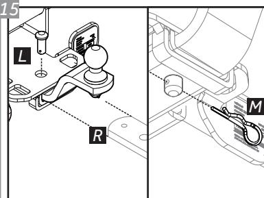
Deslize a Ponteira "R" para dentro, de forma que os seus furos e os do engate fiquem alinhados. Insira o Pino Travão "L" e empurre até que o furo para colocação do Grampo "M" fique visível no lado oposto.
