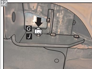
Para o lado direito do veículo, os procedimentos são os mesmos, apenas alterando a posição do Parafuso "A" que corresponde ao destaque acima. Também montado de dentro para fora.
