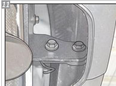
Com os dois Suportes montados, posicione o Conjunto Estrutura "O" entre eles. Para a fixação, utilize Parafusos "B", Arruellas "H" e Porcas "F". Instale as fixações do pára-choque novamente.
