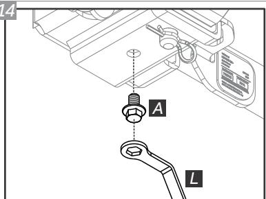
Após posicionar a Ponteira, localize o furo para inserir o Parafuso Anti Ruido, item "A". Aperte o mesmo para evitar que a trepidação do veículo, em terrenos irregulares, gere ruídos indesejados.
