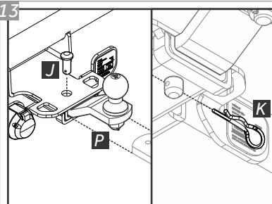
Deslize a Ponteira "P" para dentro, de forma que os seus furos e os do engate fiquem alinhados. Insira o Pino Travamento "J" e empurre até que o furo para colocação do Grampo "K" fique visível no lado oposto.
