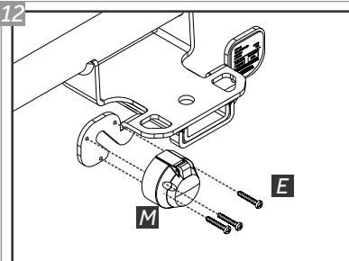
Posicione a Tomada "M" no conjunto estrutura nas furações indicadas e insira os Parafusos "E". Para fixar a tomada, utilize a chave phillips.
