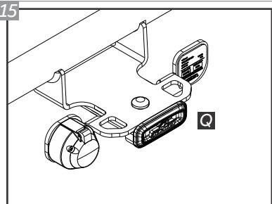
Observe que, quando o engate não for utilizado, a Ponteira deve ser substituída pela Tampa de Proteção "Q". Após colocada, a tampa de proteção deverá ser fixada com o Pino Travamento "J" e com o Grampo "K" afim de evitar a perda da mesma.
