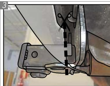
3 Remova a pequena aba central presente na parte inferior do parachoque traseiro, utilizando um estilete, conforme a imagem acima.
