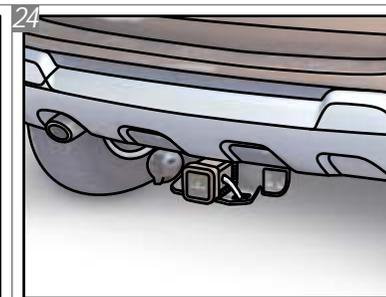
Após colocada, a tampa de proteção deverá ser fixada com o Pino Trava "O" e com o Grampo "N" afim de evitar a perda da mesma.
