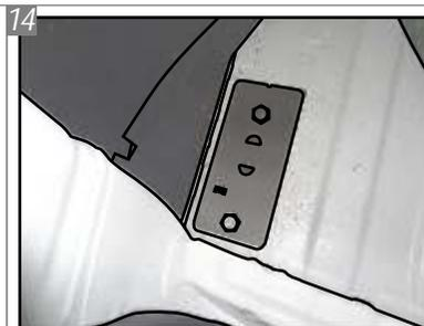
Reposicione as Chapas Superiores "K" e "L" e fixe-as, com Parafusos "C", Arruelas "H" e Porcas "E". Os parafusos devem atravessar o porta malas, até chegar na parte de baixo do chassi.
