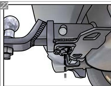
Após posicionar a ponteira K1, localize o o manipululo anti-ruído, na parte inferior do engate. Aperte o mesmo para evitar que a trepidação do veículo, em terrenos irregulares, gere ruídos indesejados.
