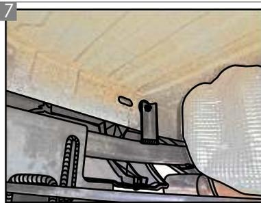
7 Posicionar o Conjunto Estrutura "Q" nas fixações centrais aparentes.
