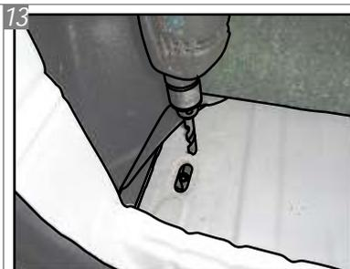
Realize os furos demarcados anteriormente, utilizando a broca de 13mm.
