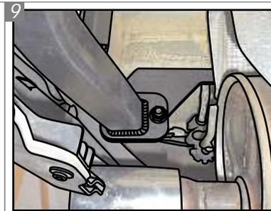
9 Utilize os Parafusos "A", juntamente com Porcas "E" e Arruelas "H", para prender os Suportes "P" ao conjunto.
