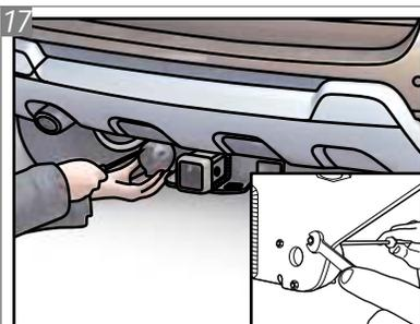
Posicione a Tomada "M" no conjunto estrutura nas furações indicadas e insira os Parafusos "B", com Porcas "F". Para fixar a tomada, utilize a chave phillips e chave 8.
