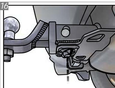
Posicionada a ponteira K1, na parte inferior do engate há um manipulo anti-ruido. Aperte o mesmo para evitar que a tremidação do veículo em terrenos irregulares gere ruídos indesejados.
