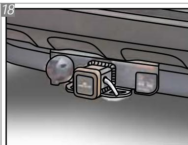
Após colocada, a tampa de proteção deverá ser fixada com o Pino Travá "N" e com o Grampo "M" afim de evitar a perda da mesma.
