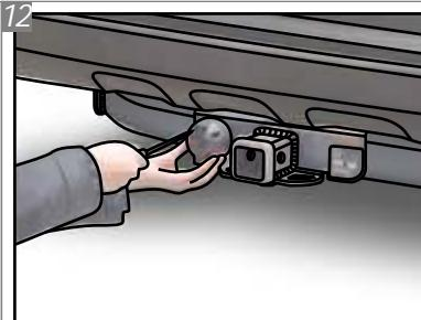
Posicione a Tomada "L" no conjunto estrutura nas furações indicadas e insira os Parafusos "C", com Arruelas "H".
