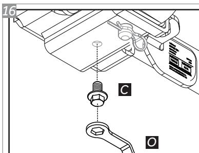
Após posicionar a Ponteira, localize o furo para inserir o Parafuso Anti Ruído, item "C". Aperte o mesmo para evitar que a tremulação do veículo, em terrenos irregulares, gere ruídos indesejados.
