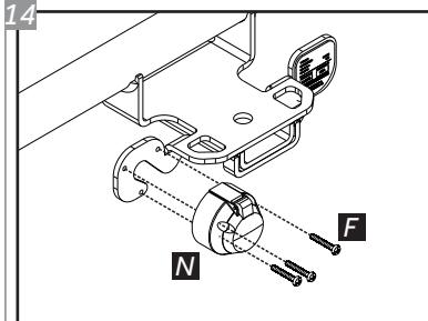
Posicione a Tomada "N" no conjunto estrutura nas furações indicadas e insira os Parafusos "F". Para fixar a tomada, utilize a chave phillips.
