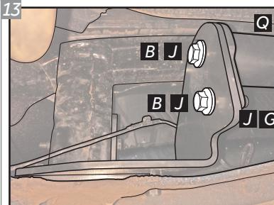
Com os dois Suportes montados, posicione o Conjunto Estrutura "Q" entre eles. Para a fixação, utilize Parafusos "B", Porcas "G" e Arruelas "J". Instale a peça plástica removida no passo 5 novamente no veículo. E recoloque as fixações do parachoque e do escapamento.
