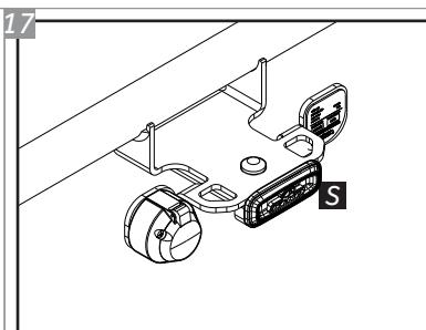
Observe que, quando o engate não for utilizado, a Ponteira deve ser substituída pela Tampa de Proteção "S". Após colocada, a tampa de proteção deverá ser fixada com o Pino Travão "L" e com o Grampo "M" afim de evitar a perda da mesma.
