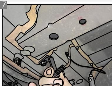
Passé as duas Travas "L", pelos furos feitos anteriormente. Posicione-as de modo que seus parafusos fiquem para fora dos furos inferiores e as porcas alinhadas com os furos laterais.
