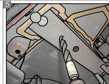
Com uma broca de 11,2mm, fure o chassi onde a marcação foi feita na parte inferior. Após, repasse os dois furos inferiores, com uma broca de 19mm, para possibilitar a passagem das travas.
