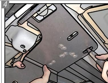
Posicione o Suporte "P" no veículo e faça marcações no chassi, dos dois furos laterais e no inferior, para depois furar. NOTA: Tome o furo original do chassi e a fixação traseira como referência de posicionamento.
