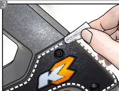
Passe o Primer "U" na capa externa, onde a Sobrecapa será colocada posteriormente, nas regiões que estarão em contato com a fita dupla face (imagem seguinte).
