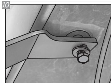
**Fixe os suportes com Parafusos "C" e Arruelas "E", sem dar aperto final. Faça os passos 1-10 nos dois lados do veículo.**
