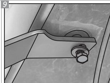
Fixe os suportes com Parafusos "C" e Arruelas "E", sem dar aperto final. Faça os passos nos dois lados do veículo. Para utilização com grade de vidro, substitua os Parafusos "C" pelos Parafusos "B".
