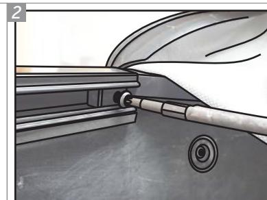
**Solte os parafusos que prendem os perfis laterais ao perfil traseiro da capota. Remova os perfis, temporariamente.**
