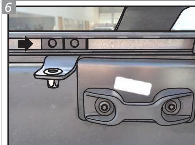
Instale o Santantônio na sua posição, com o auxílio das Arruelas "G" e Parafusos "D" nos ganchos. Posicione os perfis e desloque a fixações internas para a posição mostrada na imagem acima.
