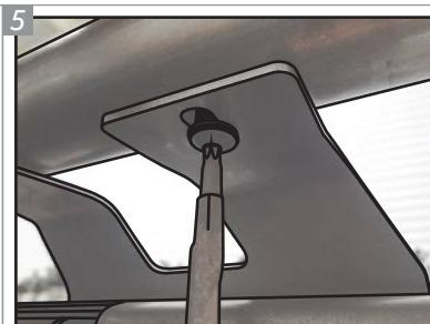
**Posicione a Estrutura "N" em cima da caçamba. Caso o encaixe não seja possível, afrouxe os parafusos das bases.**
