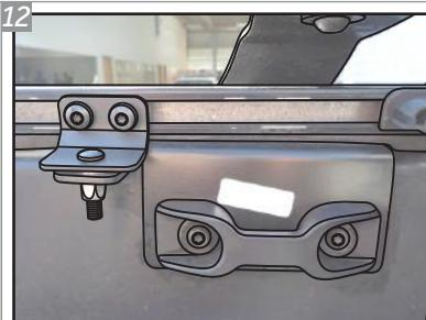
Fixe o Suporte Auxiliar "L" ao Suporte do Santantônio utilizando o Parafuso "K". Utilizando os parafusos originais, fixe o Suporte "L" aos perfis da capota. Aperte todas as fixações e monte a capota normalmente.
