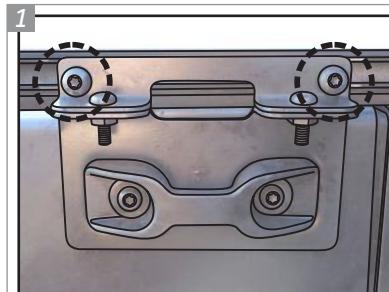
**Solte os parafusos que prendem os perfis laterais aos suportes da capota Flash Cover. Remova os perfis, e os parafusos temporariamente.**
