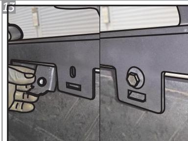
Posicione as Travas Laterais "J", por dentro da aba da caçamba, nas partes dianteira e traseira, com Parafusos "C" e Arruelas "G", como nas imagens acima. Repita para o outro lado.
