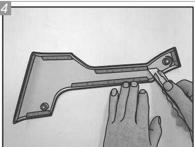
Na parte interna das Sobrecapas "P" e "Q", remova os filmes que cobrem os adesivos.
