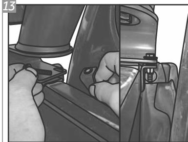
Posicione a Trava de Fixação "J" na parte frontal da caçamba, unindo-a com a base, com o auxílio de um Parafuso "D" e uma Arruela "G". Repita para o outro lado.
