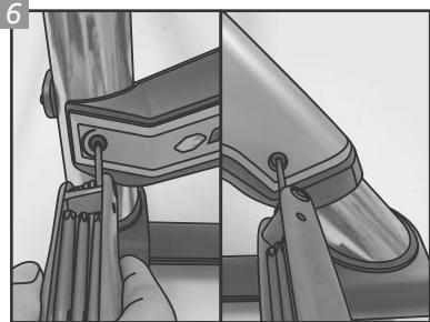
Para assegurar a fixação da Sobre capa, utilize dois Parafusos "R", como na imagem acima. Repita os procedimentos 1-6 para o outro lado.
