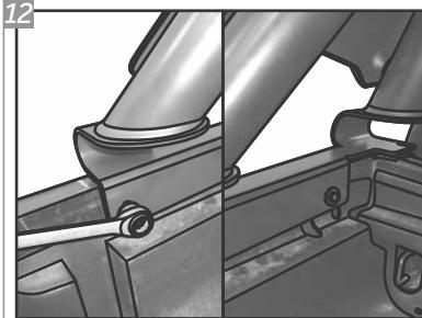
Coloque um Parafuso "C" com uma Arruela "H" em cada furação da lateral da base. Repita para o outro lado.
