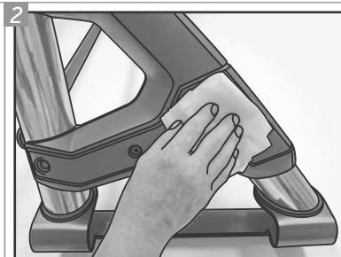
Limpe a capa externa, na área onde será colocada a Sobrecapa, com álcool isopropílico para que a cola tenha boa aderência.
