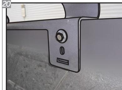
Com os Rebites instalados, utilize os Parafusos "C" com Arruelas "H" para fixar o Santantônio na caçamba. Repita os procedimentos no outro lado.
