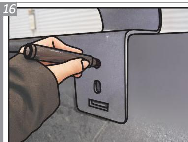
Caso não seja possível instalar as Travas "L", marque os três furos superiores no protetor de caçamba e remova temporariamente os suportes.
