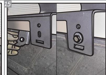
Posicione as Travas Laterais "L", por dentro da aba da caçamba, nas partes dianteira e traseira, com Parafusos "C" e Arruelas "H", como nas imagens acima. Repita para o outro lado.
