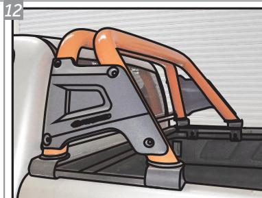
Coloque o acessório na sua posição e ajuste as bases na caçamba. Depois, aperte os parafusos M12.
