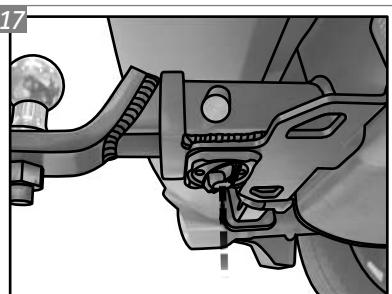
Após posicionar a ponteira K1, localize o manipulo anti-ruído, na parte inferior do engate. Aperte o mesmo para evitar que a trepidação do veículo, em terrenos irregulares, gere ruidos indesejados.
