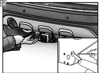
Posicione a Tomada "M" no conjunto estrutura nas furações indicadas e insira os Parafusos "B", com Porcas "F". Para fixar a tomada, utilize a chave phillips e chave 8.
