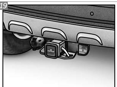
Após colocada, a tampa de proteção deverá ser fixada com o Pino Trava "O" e com o Grampo "N" afim de evitar a perda da mesma.
