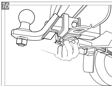
Posicionada ponteira K1, na parte inferior do engate há um manipulo anti-ruido. Aperte o mesmo para evitar que a tremulação do veículo em terrenos irregulares gere ruídos indesejados.
