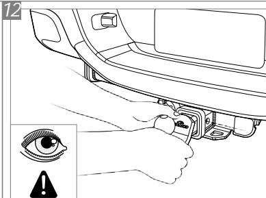
Deslize-a para dentro de forma que os furos da ponteira K1 e do engate fiquem alinhados.
