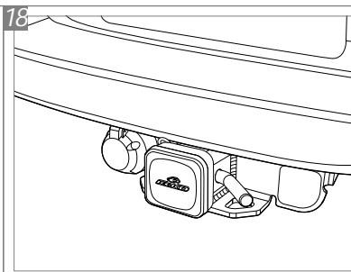
Após colocada, a tampa de proteção deverá ser fixada com o pino trava "H" e com o grampo "G" afim de evitar a perda da mesma.
