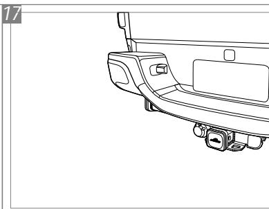
Observe que quando o engate não for utilizado e a ponteira K1 for removida, deve-se colocar a tampa de proteção no local da mesma.
