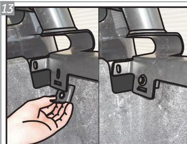
Posicione as Travas Laterais "J", por dentro da aba da caçamba, na parte dianteira, com Parafusos "C" e Arruelas "E", como nas imagens acima. Repita para o outro lado.
