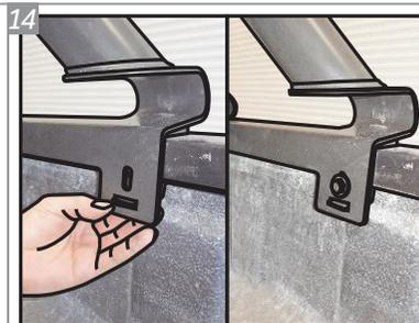
Posicione as Travas Laterais "J", por dentro da aba da caçamba, na parte traseira, com Parafusos "C" e Arruelas "E", como nas imagens acima. Repita para o outro lado.
