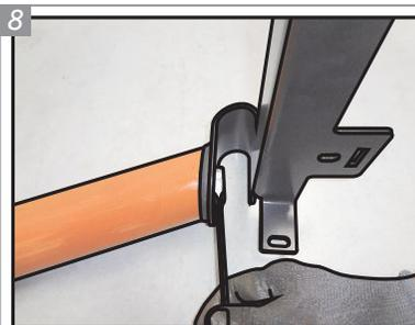
**8** Para fixar o Contorno Dianteiro "P" à Base Direita "N", utilize Parafusos "B" e Arruelas "H", sem dar o aperto final.
