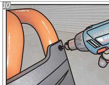
**10** Dar aperto final nos parafusos das capas. Se necessário, utilize uma parafusadeira.
