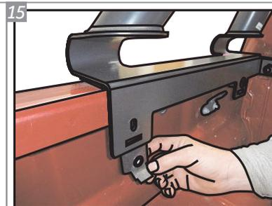
Posicione as Travas Laterais "J", por dentro da aba da caçamba, nas partes dianteira e traseira, com Parafusos "C" e Arruelas "G", como na imagem acima. Repita para o outro lado.
