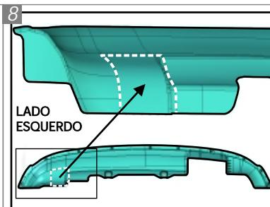
Com uma serra, faça um recorte no lado esquerdo da peça plástica, previamente removida, onde possui interferência com o Suporte (de acordo com linha branca pontilhada acima). Após, recoloque a peça em sua posição original.
