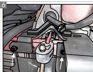
Posicione o Suporte "O" alinhando com os parafusos no chassi. Para fixar cada trava, coloque uma Arruela "F" com Porca "E" e dê aperto.
