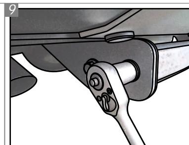
Posicione o Conjunto Estrutural "P" entre os Suportes e fixe-os, com Parafusos "A", Arruelas "H" e Porcas "D". Dê o aperto final em todas fixações.
