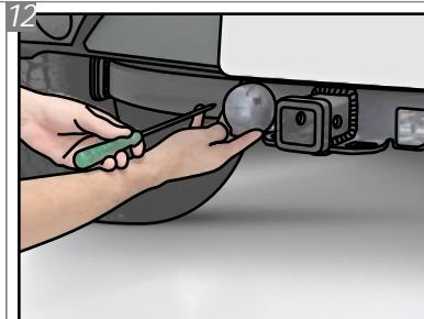
Posicione a Tomada "L" no conjunto estrutura nas furações indicadas e insira os Parafusos "C", com Arruelas "G". Para fixar a tomada, utilize a chave phillips.
