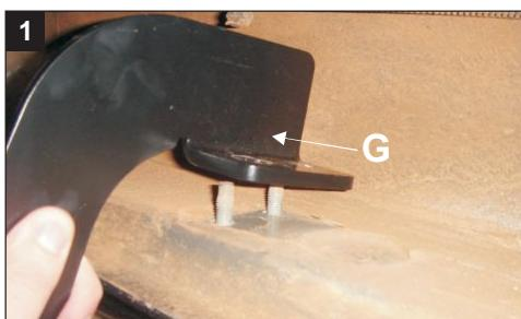
Pela parte da frente do veículo, posicionar o suporte "G" de forma que um dos oblongos se encaixe no parafuso existente no chassis do veículo.
