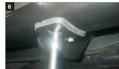
Das Gestell "G" an der Frontseite des Vehikels anbringen, so dass eine der ovalen Öffnungen in die Schrauben passt, die sich im Gehäuse des Vehikels befinden.
