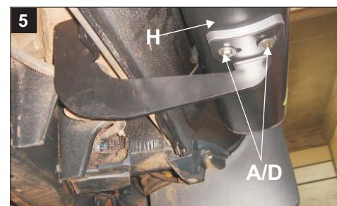
Fixar o tubo base "H", utilizando os parafusos "A" e arruelas lisas "D".
